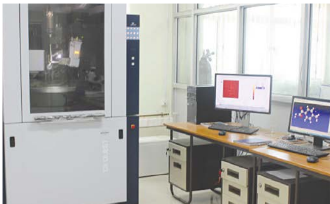
सिंगल क्रिस्टल एक्सआरडी फैसिलिटी ऑफ सैफ-आईआईटी पटना
